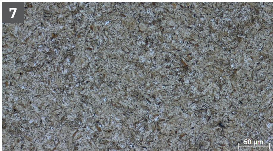
0,45 % C Martensita y bainita. Acero hipoeutectoide. Austenización a 850 °C durante 25 minutos y enfriado en agua.
