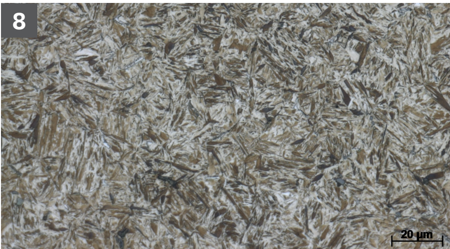
0,45 % C Principalmente martensita y bainita y algunas inclusiones de sulfuro. Acero hipoeutectoide. Austenización a 850 °C durante 25 minutos y enfriamiento en agua.
