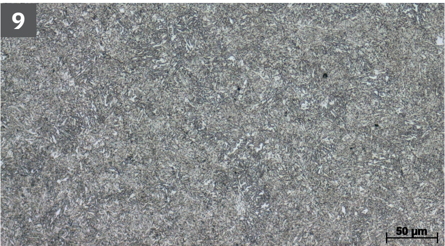
0,45 % C Martensita (templada). Acero hipoeutectoide. Austenización a 850 °C durante 25 minutos, enfriado en agua y templado a 650 °C durante 1 hora.
