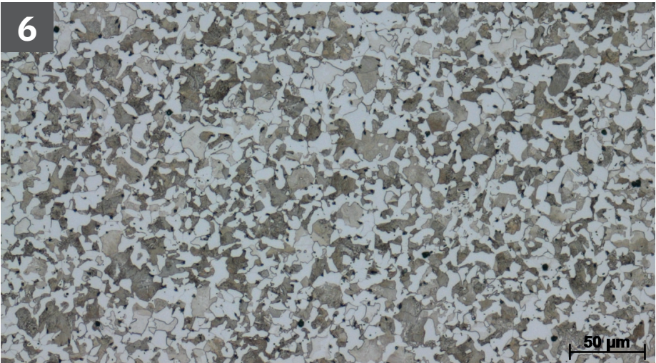
0,45 % C Pearlita (oscura) y ferrita (claro). Acero hipoeutectoide. Normalizado.
